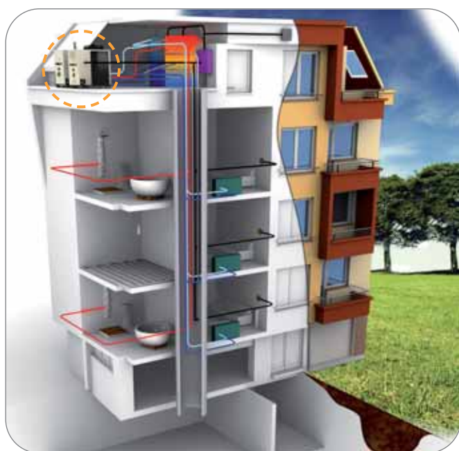
Пример использования аппарата GA-HR с тепловым насосом реверсивный вариант GAHP-AR в летнем режиме для системы с фанкойлами и непрямым производством ГВС.
